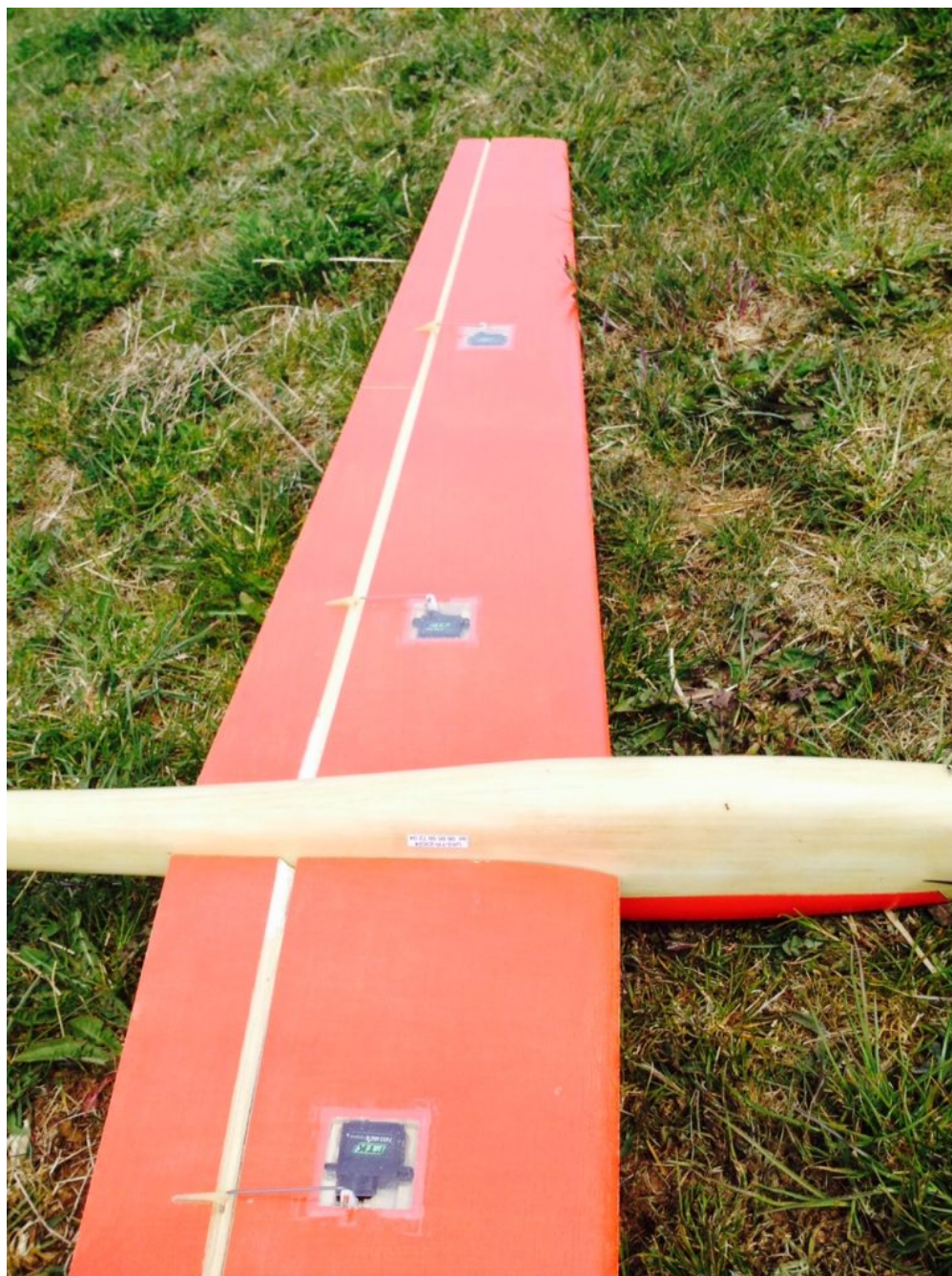
Articulations de gouvernes en tissus d'arrachage à 27% de la corde d'aile.
