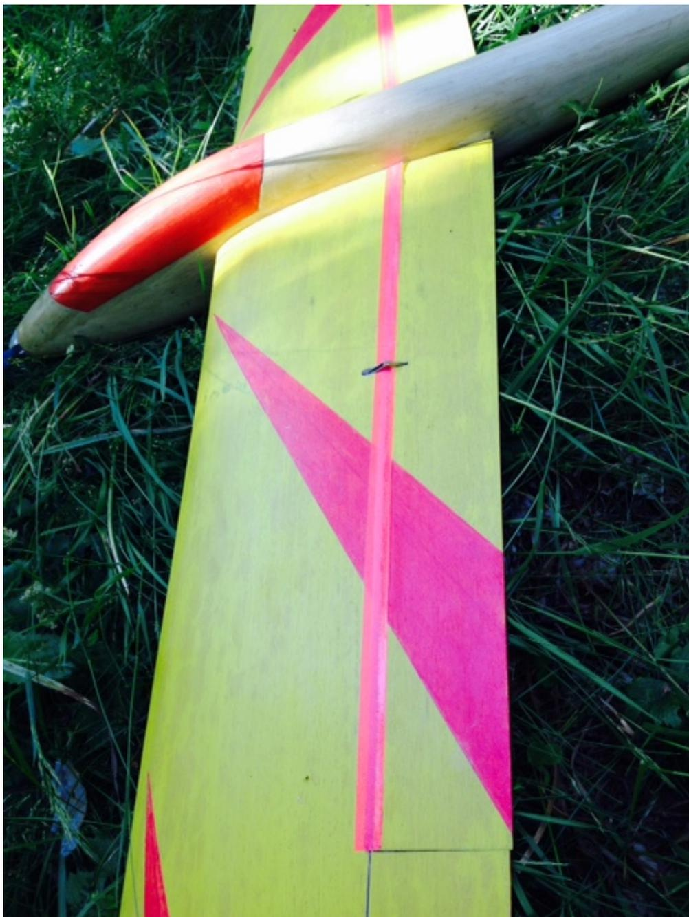
Les volets (rigidifiés au coffrage par du carbone tissé biaxial de 60gr (du 30gr aurait suffi) sont articulés à l'intrados à 33% de la corde d'aile. Très efficaces avec le profil sb96V, la fente est calfeutrée au scotch « washy-tape ».
