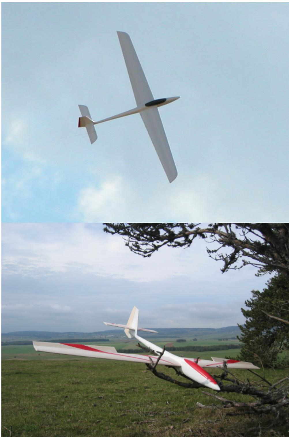
Le **Psycho** 1994 : 2m30 Modifié depuis, empennage allégé et volet de dérive agrandi. Chargé à 46gr/dm<sup>2</sup> ce planeur robuste demande plus de 10 km/h de vent pour s'exprimer sur une petite pente. Sa voilure un peu lourde devient un avantage sur une pente turbulente.
