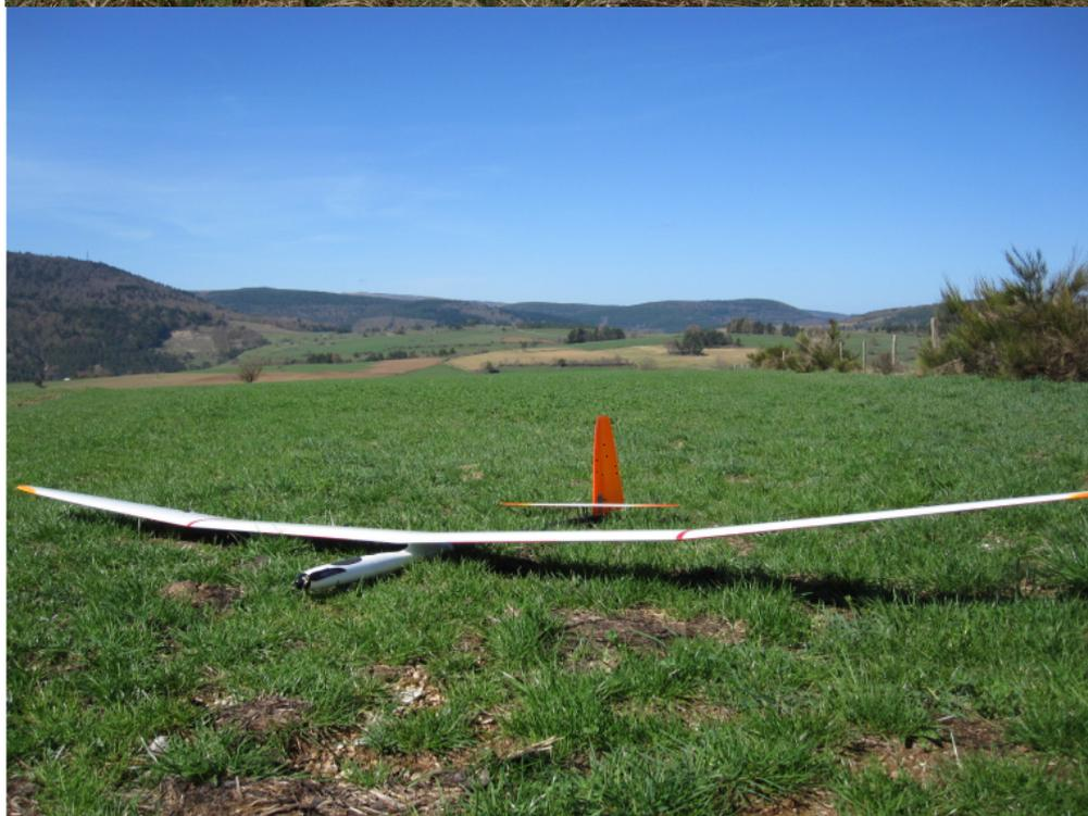
**Orion** depuis 2014 : 2,4 m chargé à 35gr/dm<sup>2</sup> motorisé »remonte trou » et polyvalent, encore bien visible à 200 m et plus selon l'arrière plan.
