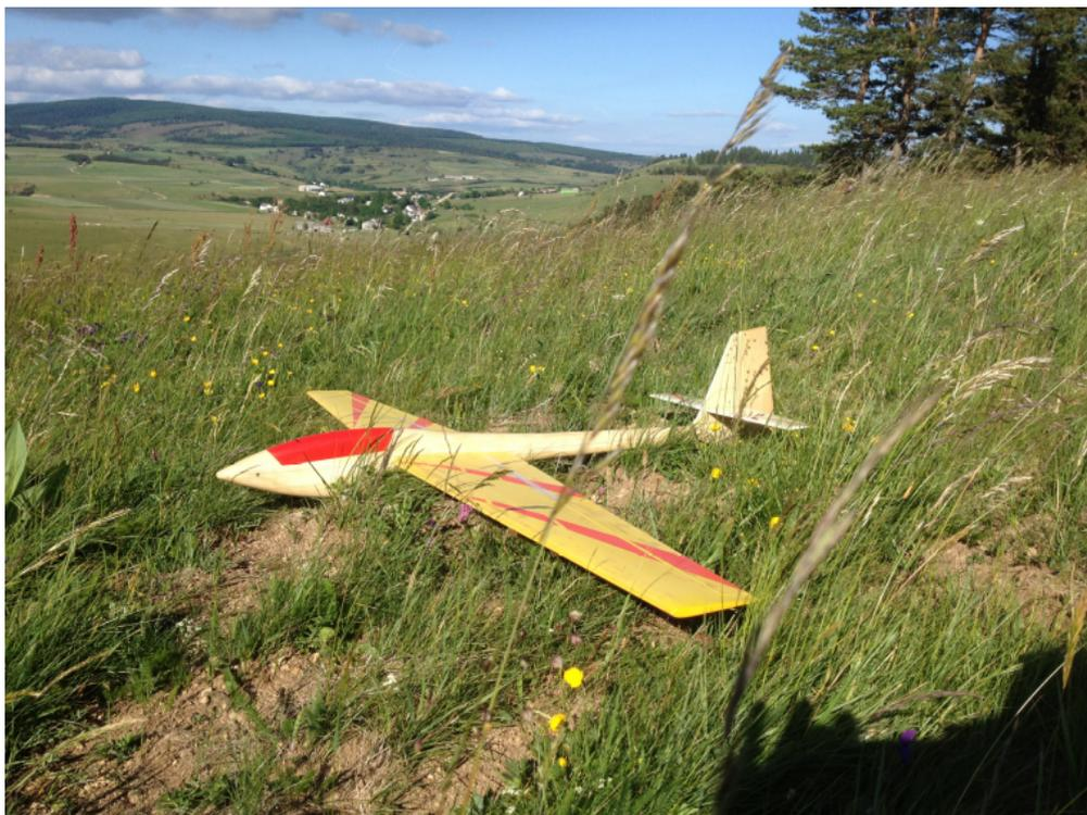
[Voltij 2006](#) : Planeur novateur de 2000 taillé pour le pilotage 4 axes, profil symétrique MG 05, 2m chargé à 45gr/dm<sup>2</sup> un régal pour les figures inversées et le vol tranche dans la dynamique.
