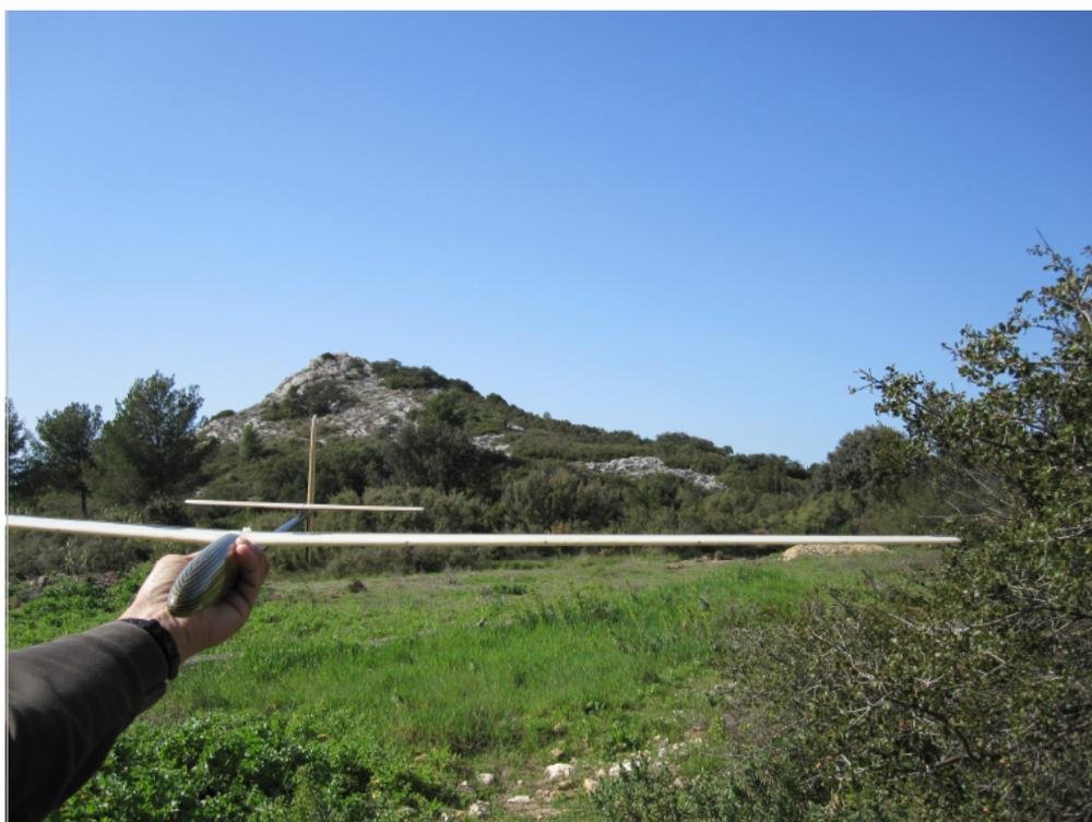
Le **Pixel** original 1990 à profil sb 96 : dérivé à de l'Axel est un planeur malin à incidence variable (calage variable et différentiel pour les puristes) qui se pilote sans direction sur 2 axes (roulis et tangage), fin pour son format il restitue étonnamment en voltige ample et gratte avec agilité. Il est délicat à poser s'il n'est pas présenté à sa bonne vitesse, trop lentement il ne pourra pas allonger et posera court, trop vite il effacera la piste surtout sur une aire porteuse.
