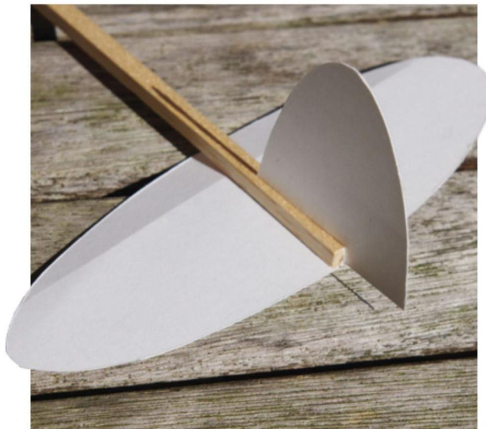
En pliant le bord d'attaque de l'empennage horizontal, vous pouvez influencer l'angle d'attaque dans une certaine mesure et ainsi régler le modèle pour le vol droit
